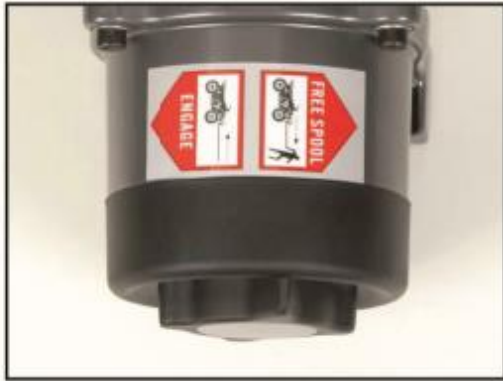
Kuva 7a Vapaapyörä vapautettuna (vapautettu asento)
