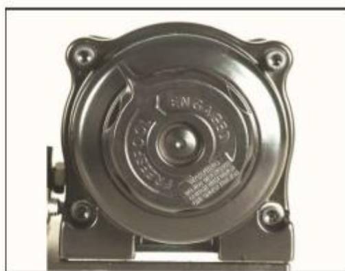
Kuva 6b Vapaapyörä kiinni kytkettynä
