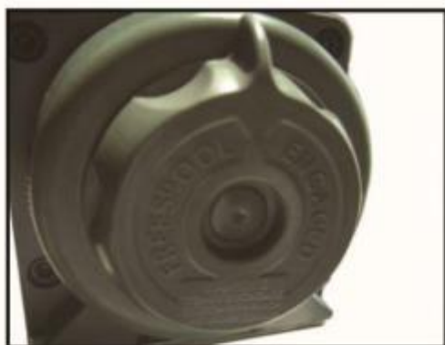
Kuva 5a Vapaapyörä vapautettuna (vapautettu asento)
