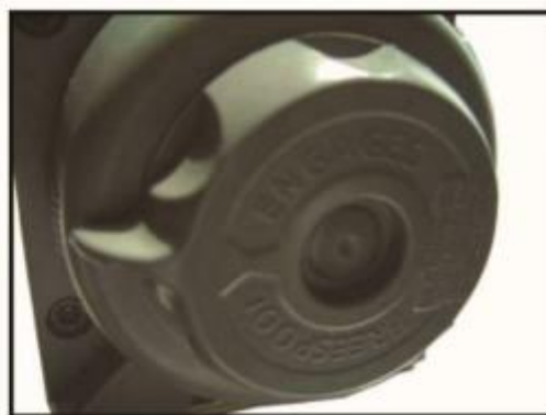
Kuva 5b Vapaapyörä kiinni kytkettynä
