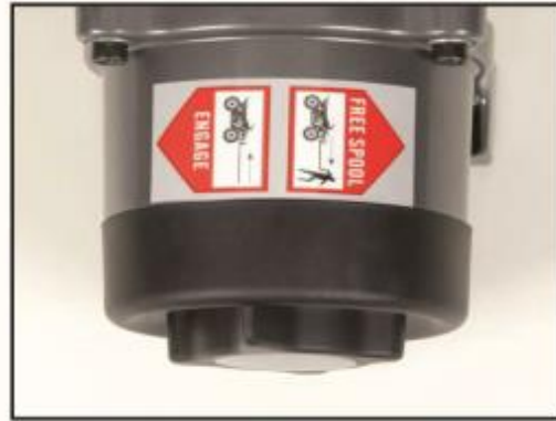
Kuva 7b Vapaapyörä kiinni kytkettynä
